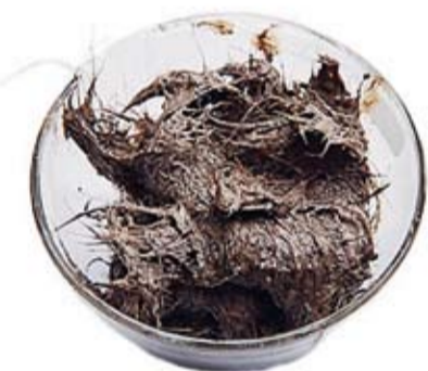
Ganz schön zäh ist die Paste, mit der die Tester unter Laborbedingungen die Abflussrohre verstopften. Dann mussten die Reiniger zeigen, was sie leisten.
